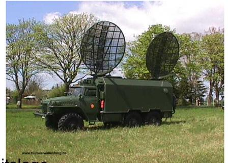
Sendeempfangsfahrzeug R 412A auf Lkw Ural 375D in Arbeitslage
